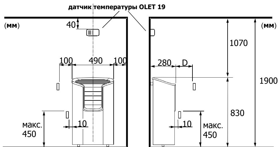
Рисунок 1. Безопасные расстояния для установки электрокаменки
